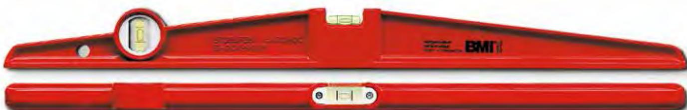
Schwere Aludruckguss-Wasserwaage in Trapezform. Messfläche gefräst. Wasserwaagenkörper rot pulverbeschichtet. Sehr hohe Verwindungssteifigkeit. Messgenauigkeit in Normallage 1,0 mm/m.
