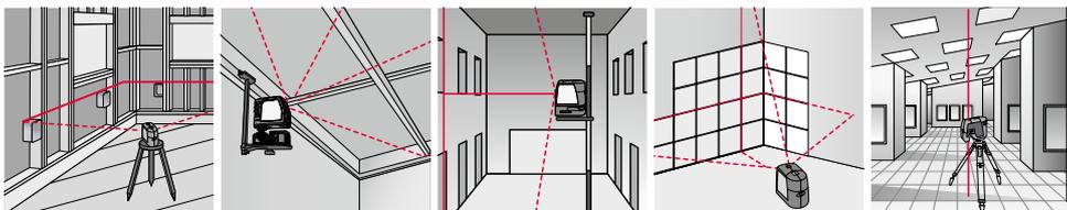
**Meterrisse für Böden, Elektrik, ...**    **... Decken abhängen**    **Vertikale Linie (Schreinerarbeiten)**    **Laserkreuz um Fliesen auszurichten**    **Lotstrahl oben und unten**
