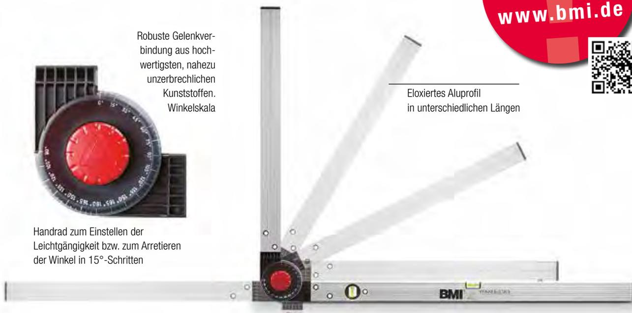
Robuster, zusammenklappbarer Bauwinkel **zum stufenlosen Übertragen oder Abnehmen von Winkeln von 0° bis 270°**. In 15°-Schritten können die Winkel fest arretiert werden. Durch die eingebauten Libellen als Wasserwaage verwendbar. Leicht zu transportieren. In unterschiedlichen Größen lieferbar.
